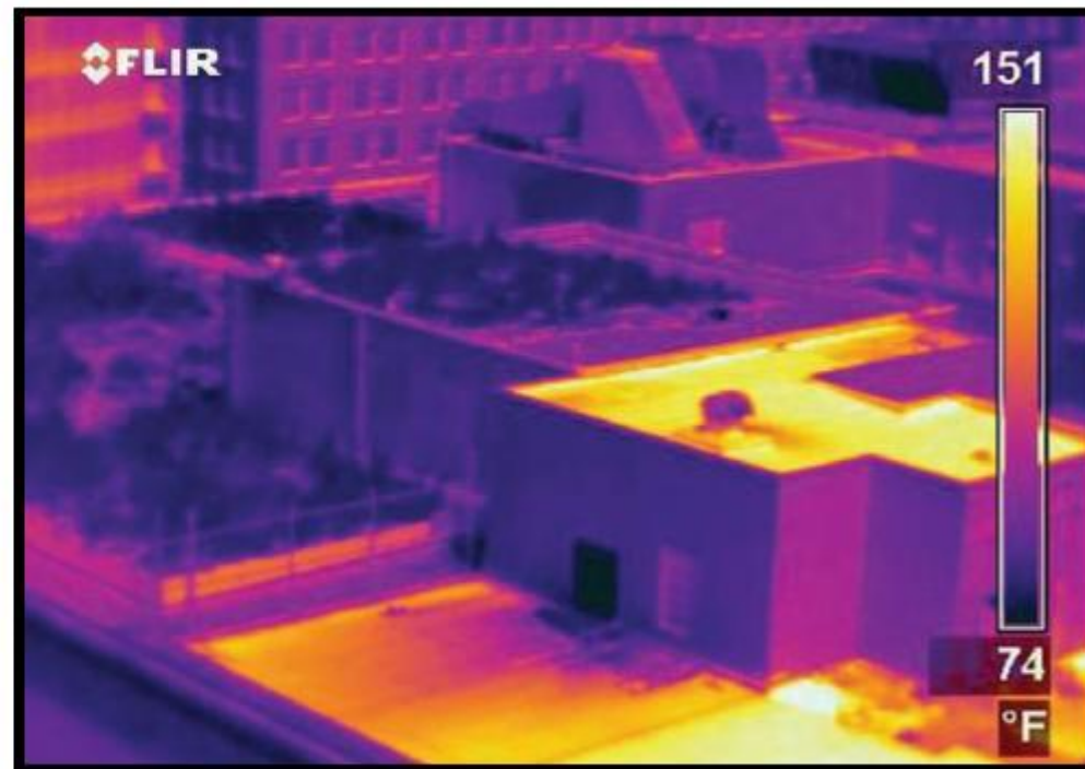
Slika 8. Razlika između zelenog i konvencionalnog krova: tokom uobičajenog ljetnog dana u Čikagu utvrđeno je da je temperatura zelenog krova bila i do 40^{\circ}\text{C} hladnija od temperature konvencionalnog krova. Uobičajena slika - lijevo, termalni snimak - desno (Izvor: Reducing Urban Heat Islands: Compendium of Strategies „Green roofs“)
