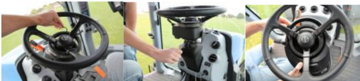
Slika 5. Instalacija sustava Ag Leader OnTrack3 (tzv. “Lock-n’-Roll” instalacija)
