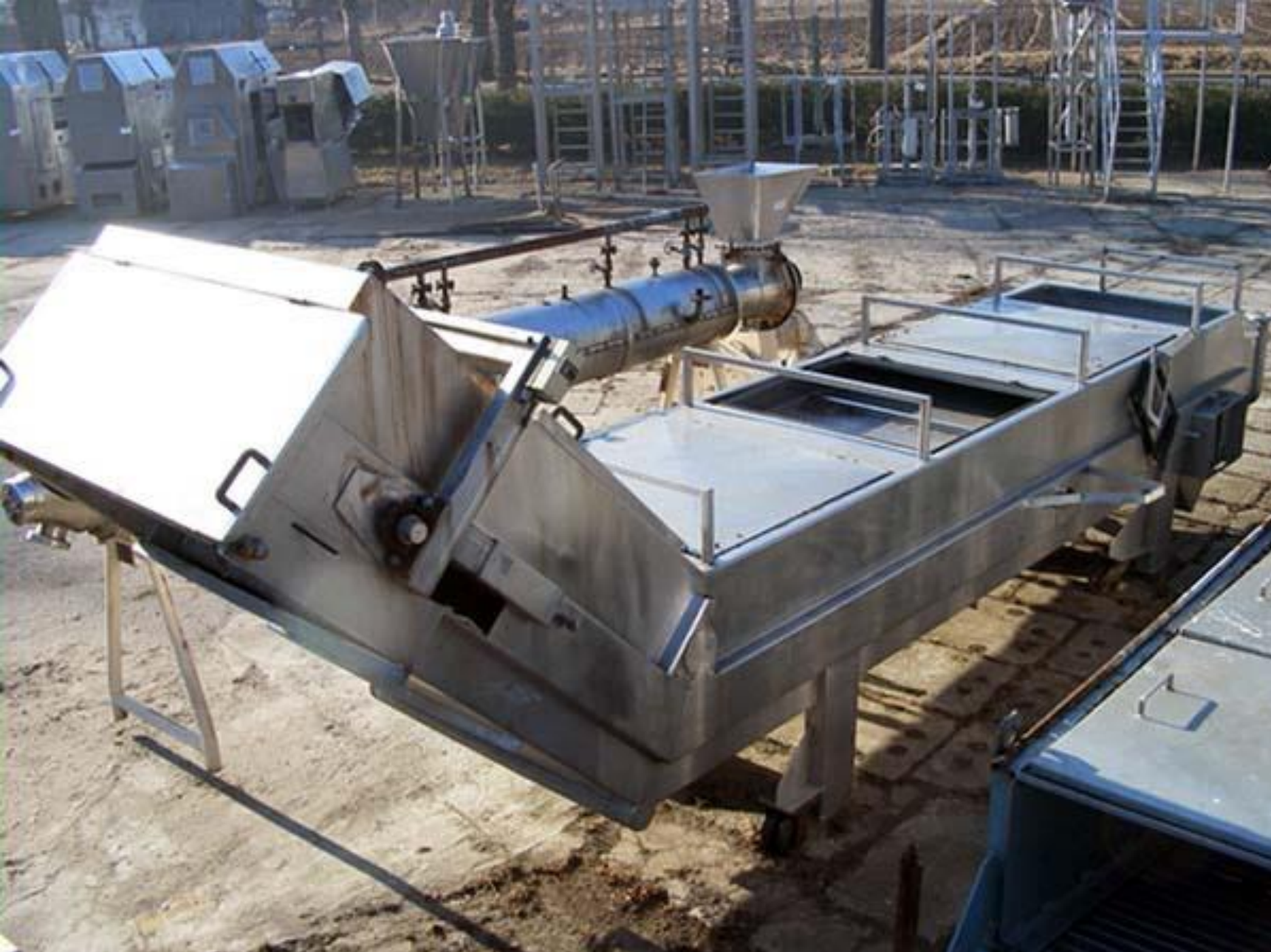
Blanšer sa pokretnom trakom - kapacitet 1500 kg/h zavisno od temperature i veličine uzorka
