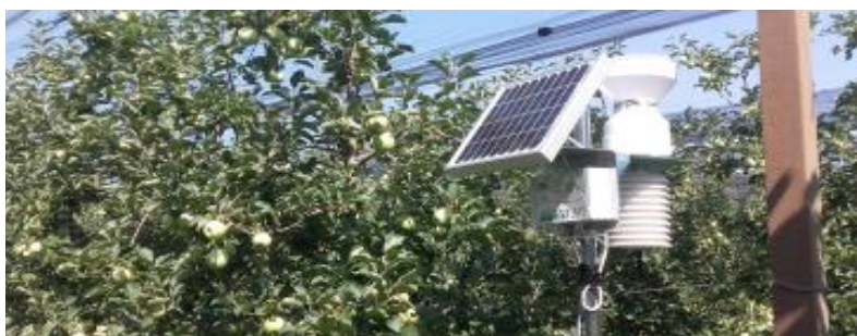
Slika . Agrometeorološka stanica (Izvor:Pinova meteo)
