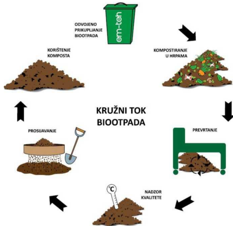
Slika 2. Kompostiranje bio otpada ( http://www.emteh.hr/kompostiranje-bio-otpada/ . 2016.)
