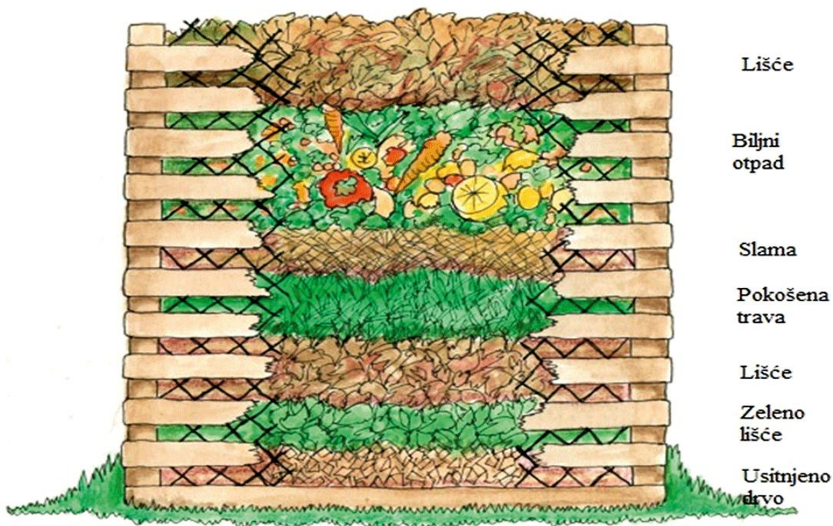
Slika 9 - Slojevi u kompostnoj gomili (Izvor: https://gospodarski.hr/rubrike/ostalo/prilog-broja-kompostiranje-i-gospodarenje-tlom/ )
