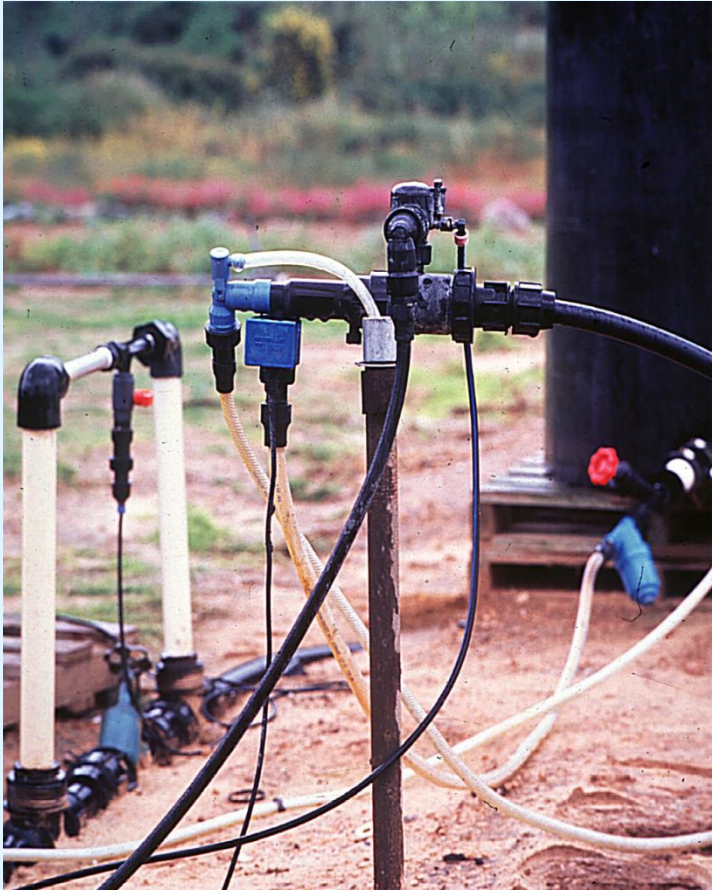
PUMPA ZA ISTISKIVANJE TEČNIH GNOJIVA NA VODENI POGON
