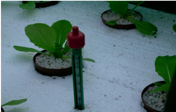
Sl. 3. Termometar za mjerenje temperature rastvora
